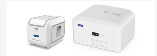
김봉석 R&D총괄이사, 임원래 책임연구원, 정광진 수석연구원이 개발한 미세액적(Micro-droplet)기반 디지털 PCR은 DNA나 RNA와 같은 극소량의 유전 물질을 포함한 샘플을 수만개의 작은 방울들로 나누어서 계수하고 측정하는 데 사용되는 강력한 기술이다. 세계 최초로 분석 후 샘플이 포함된 시료를 원래 처음의 시작점 튜브에 이송 시키는 기술을 접목하여 효율성을 극대화했다.
