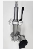
양승훈 센터장, 이석원, 박승영, 김종연 책임연구원이 개발한 전동식 조향장치는 운전자의 스티어링 휠 조작 신호를 감지하여 필요한 조타력을 생성해내는 전동 장치이다. 기존 C-EPS의 구조를 최적화함으로써 큰 폭의 경량화를 달성한 것이 가장 큰 특징이며, 같은 차종의 전 세대 모델 대비 최대 22%까지 절감했다.
