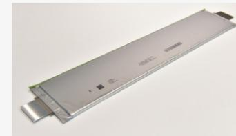
최정석 책임, 정원희 상무, 이재현 연구위원이 개발한 제품은 EV 모듈러 플랫폼에 적용되어 20종 이상의 차량에 공용으로 적용 가능한 고용량/고안전성 셀이다. 고함량 니켈(Ni)의 NCM 조성에 알루미늄(Al)을 첨가하여 고용량과 안전성이 동시에 확보된 양극재를 사용하고, 극재의 입자크기와 혼합비율을 최적화하여 저항, 수명, 안정성 등 제품 성능과 전극 생산성을 동시에 확보했다.
