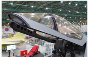
선석진 수석연구원, 정하택 책임연구원, 이재훈 선임연구원이 개발한 캐노피는 전투기 운용 중 조종사를 보호하고 조종사 시야 확보 및 조종사가 타고 내릴 수 있도록 개폐 기능을 갖추고 있다. 전투기 운용 시 발생 가능한 조류 충돌, 낙뢰 및 고공·고속의 극한 환경에서 조종사와 내부 장비를 보호하고, 임무 수행이 가능하도록 우수한 광학 성능을 보유한다. 또한, 유사시 조종사 탈출을 위한 신속 분리 기능도 갖췄다.
