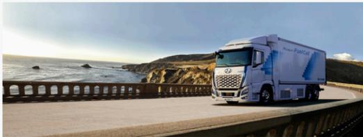
나옥진 상무, 이호영, 신재영, 염시호 책임연구원이 개발한 수소연료전지 대형트럭은 세계 최초로 양산 개발된 친환경 차량이다. 고압 탱크에 충전된 수소와 공기 중의 산소를 이용해 연료전지 발전을 하고, 이를 통해 얻은 전기에너지로 모터를 작동시켜 구동력을 발생시킨다. 충전 시간은 약 8~25분 소요되며 주행가능거리는 350바 충전 압력 기준 400km 이상 주행거리를 확보했다.
