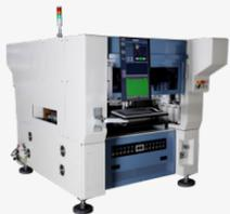
맹학도 연구소장, 정대철, 김낙훈 책임연구원이 개발한 i-12.0은 세계적인 이형 부품 자동 삽입 조립 기술에 의해 탄생된 차세대 융합 장비이다. 전자부품을 손으로 삽입공정을 자동화하여 무인화 공정에 기여했다. 또한 단자삽입 및 퓨즈삽입 공정에도 적용이 가능한 하이브리드 장비로 투자 회수 기간을 단축 및 공간 절약을 달성했고, 전자부품을 장비에 장착된 노즐과 다양한 그리퍼를 이용해 전자부품을 픽업한다.
