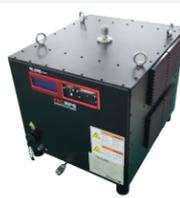
허진 부사장, 이윤성, 손영훈 프로그가 개발한 PRO-RPS는 자기 유도결합 방식의 플라즈마 발생 기술을 적용한다. 가스 분자에 가장 효과적이고 효율적으로 에너지를 전달하여 고에너지의 활성화용을 생산, 공정 챔버에 공급하는 장치로서 반도체 제조 시 플라즈마를 통해 생성된 활성화용을 활용할 수 있는 모든 공정(박막증착, 원자층 증착/식각, 표면처리, PR 스트립, 에칭)에 사용된다.
