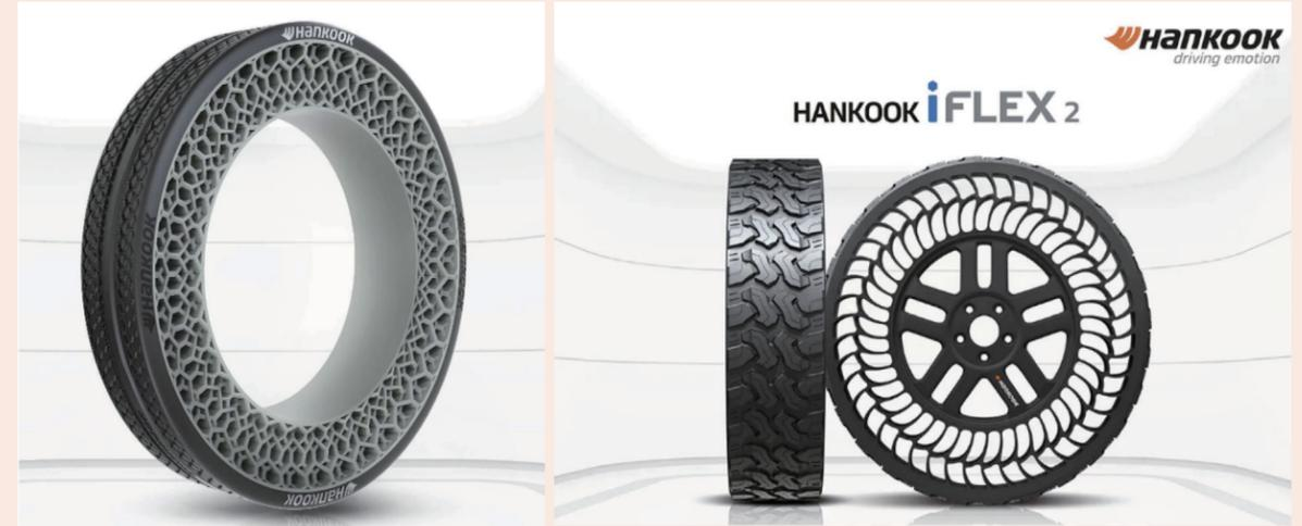
를 선보였습니다. 공기가 없어도 하중을 지지하고, 타이어로 전달된 압축 하중을 골고루 분산시킬 수 있는 구조와 재료를 확보하는 것이 관건이었습니다. i-Flex에는 벌집(honeycomb)과 아치 구조에 착안한 특수한 구조설계기술을 적용하였습니다. 기존 공기입 타이어와 다르게 내부에 공기가 없어 펑크로 인한 갑작스러운 사고에서 안전하고, 공기압의 유지 관리도 필요하지 않아 상시 최상의 기동성 유지가 가능하다는 점에서 미래 모빌리티용 Tire로서의 가능성을 다시 한번 확인했다는 데 큰 의의가 있다고 생각합니다.
