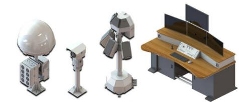
(주)케이넷츠 오경훈 CTO, 안희구 연구소장, 이승훈 전임연구원이 개발한 본 제품은 Drone의 위협적 요소(대 테러 및 비행금지구역 출몰 등)에 대응하기 위한 Anti-drone 방어 체계 구축 솔루션이다. Drone을 탐지하는 장치(RADAR), 탐지된 이동체가 drone인지 아닌지를 구분하는 식별장치 (IR Camera)와 식별을 통해 확인된 drone의 의도적인 비행을 방해하기 위한 Soft kill(Jamming System)을 통한 불법드론을 무력화 할 수 있다.
