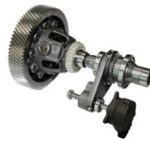
현대트랜시스(주)의 김연호 상무, 신봉주, 안중배, 오기석 책임연구원이 개발한 본 제품은 세계 최초 전기차용 AWD 디스커넥트 시스템 양산 개발한 제품이다. AWD 시스템의 구동 손실을 저감하여 1회 충전 주행거리 상승 및 필요 배터리 용량 저감으로 상품성을 확보하였으며, 내연차량 대비 조용한 전기차의 차량 주행 정숙성을 만족시킬 수 있는 세계 최고 수준의 NVH 성능을 갖추었다.
