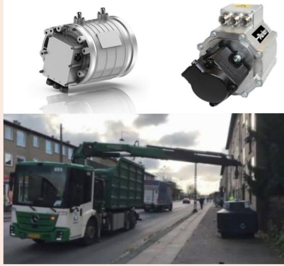
내연기관의 엔진을 대신하여 배터리로 동작하는 전기구동형 유압 발생 파워모듈 “e-PTO”(Electric Power Take-Off)가 대안으로 떠오르고 있습니다. 세계적인 파워트레인 제조업체 Z사, 글로벌 유압 및 콘트롤 메이커인 P사 등은 이미 관련 제품 또는 주요 부품을 출시하였습니다. 스웨덴의 H사는 e-PTO 탑재 크레인을 출시했고, 덴마크의 B사의 경우 대형 특수차량 PTO 시스템의 e-PTO 교체를 시작으로, 최근에는 전기차량용 e-PTO 및 기존 내연기관 차량을 전기자동차로 개조하는 키트 제품화 연구 단계까지 발전했습니다. 일본에서도 고소작업차에 T사의 ‘차량용 인버터 시스템’을 적용하여 판매 중에 있습니다.
