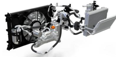
현대자동차(주) 오동석, 이승호 책임연구원, 한온시스템(주) 김원석 책임연구원, 이재민 전임연구원이 개발한 본 제품은 구동계 냉각, 배터리 열관리, 실내 공조(냉방/난방)를 수행하는 전기차 전용 플랫폼 통합 열에너지 관리 시스템이다. 고성능, 고용량 모터 및 배터리 최적 성능 구현을 위한 듀얼 냉각 시스템\*을 적용하였다.
