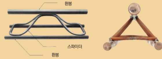
치 모양 길이는 2차선 기준으로 24~28m 정도 되므로 뼈대 1줄을 만드는데 스파이더의 용접 부위만 대략 500포인트에 달한다. 용접 부위가 많은 것은 2가지 세부적인 문제를 가진다. 용접 작업량이 많아 인건비와 용접봉 등 재료비가 많이 드는 문제와 용접 부위의 품질 불량 발생 가능성이 높아진다는 점이다. 두 번째 문제점으로 긴 길이의 아치 모양 뼈대를 만들기 위해 중간에 볼트로 연결해야 하는 부위가 필요한데 볼트 연결부위는 터널이 굴착되는 구조상 집중하중이 발생 될 수밖에 없어 구조적으로 가장 취약한 부위가 된다.
