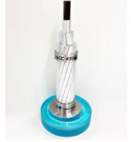
LS전선(주) 김상겸 이사, 길진수 부장, 권민석 선임연구원이 개발한 본 제품은 높은 철탍에 연결하여 전력을 보내는 가공송전선의 중심 인장선에 강철 대신 탄소 복합재를 사용함으로써, 도체로 전기저항이 낮은 연알루미늄을 사용할 수 있어 송전 용량을 기존 제품 대비 2배로 늘리고, 전력 손실은 약 20%를 감소시킨다. 일반 송전선과 동일한 금구 및 시공법을 사용하여 시공 편의성 증대되는 효과를 기대한다.
