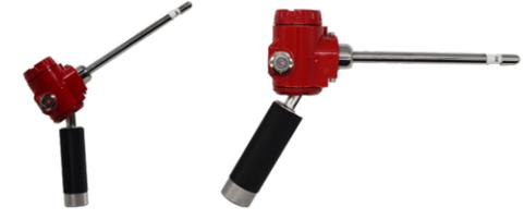
(주)이에스지케이 김귀영 연구소장, 김윤정 본부장, 김동호 부장이 개발한 본 제품은 정전기로 인한 폭발위험이 있는 산업현장에 정전기 전압을 측정할 수 있는 제품이다. 폭발성 위험 물질의 정전기를 측정하는 세계 유일의 정전기 측정기다. 국제 방폭 전기기기인증(IECEx), 유럽 CE ATEX 인증을 획득하였다. 실시간으로 데이터를 모니터링하는 시스템으로 폭발에 영향을 주는 징후를 사전에 파악하고 대응하여 재난 피해를 최소화하는 기대 효과를 가진다.
