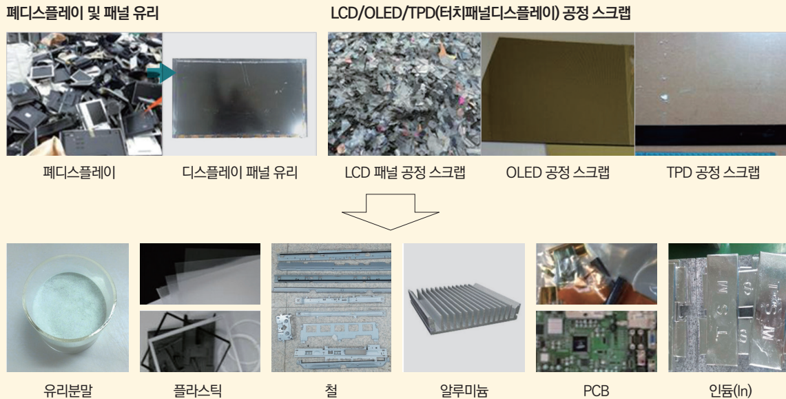
그림 1 폐디스플레이 수거-파쇄-분리선별-습식제련 공정을 통한 회수 자원
