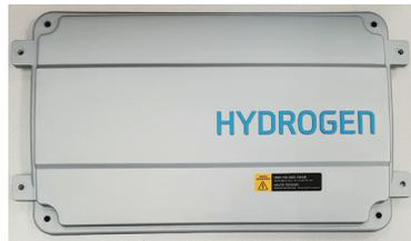
개발한 본 제품은 고전압 정션박스 케이스 하우징 재질에 사용됐던 기존 알루미늄 경량 금속 재질을 대체하여 60dB 이상 높은 전자파 차폐 성능을 구현하며, 부품 경량화 30%와 원가절감 50% 효과가 있습니다.
