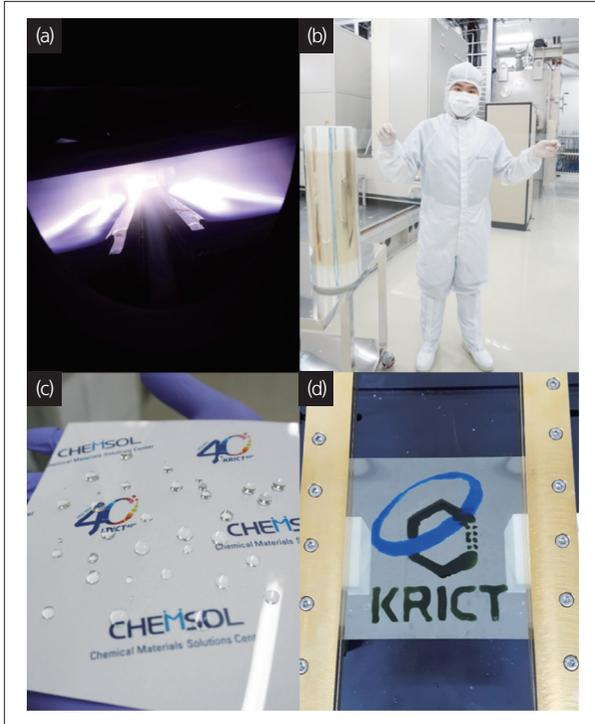
**그림 3.** (a) 대면적 복합타깃 표면의 플라즈마, (b) PET 기재 위에 연속적으로 제작된 PPFC 코팅 필름, (c) 투명하고 발수성이 우수한 PPFC 박막 샘플 사진 (d) PPFC 박막이 적용된 자가세정 투명 히터
