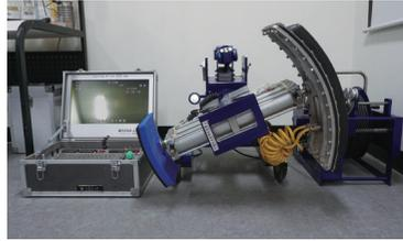
시스템은 지수재 충전공법으로 비굴착 하수관로 보수공법의 완성을 실현하였습니다. 지수재 충전공법은 모든 하수관로에 사용이 가능하며, 지수재 충전으로 하수관로 누수를 원천적으로 차단, 관 외부 토양의 공극을 메워줄 수 있어 지반 함몰의 위험을 예방할 수 있는 기술입니다. 또한 불명수를 원천적으로 차단하여 막대한 수처리 비용을 절감할 수 있습니다.
