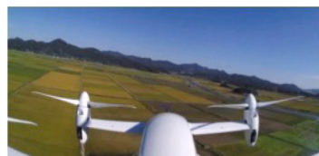
<제작된 블레이드와 허브를 장착한 체계 비행 시험>
