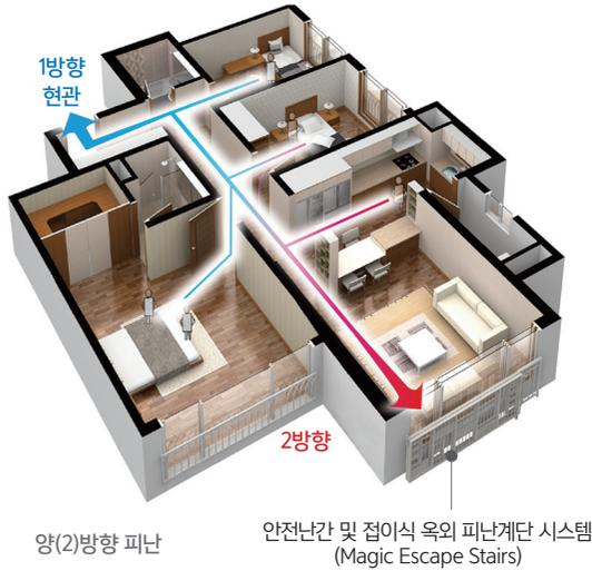
시스템이 작동되면 모든 하부층의 안전난간이 피난계단으로 변하면서 빠르게 전개되는데, 별도의 동력 없이 중력을 활용한 전개 방식이며 도미노 형식의 하향 슬라이딩으로 이뤄지기 때문에 오작동 위험 가능성도 없다. 마찰 응력과 중력 가속도를 고려하여 설계되었기 때문이다.
