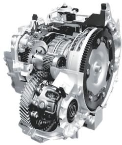
그림 3 전륜 및 후륜 자동변속기의 구조
