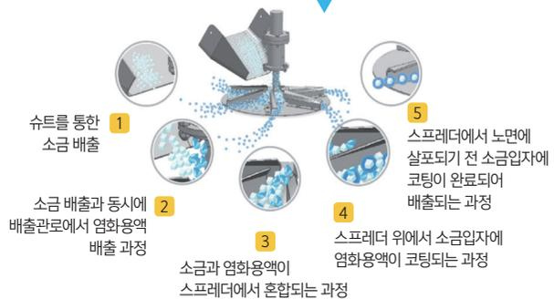
이렇듯 효율적인 습염식 제설 방법에 더하여 제설 작업시 동일한 시간 대비 용빙 속도를 어떻게 향상시킬 것인가에 대한 해법으로 (주)자동기(이하 자동기)는 수요기관의 다양한 아이디어를 접목시켜 제설제 살포기 엔진 가동시 발생하는 160℃ 이상의 배기가스 폐열과 유압 구동장치에서 발생하는 65℃ 이상의 폐열을 회수하여 제설 용액을 히팅하여 도로에 살포하는 기술을 개발하게 되었다.
