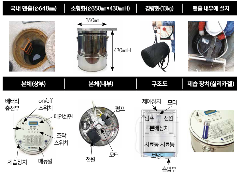
그림 2 자동 채수 장치 구조
