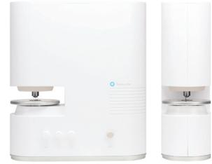
엘지디스플레이(주) 박관호 책임연구원, 이성태 책임연구원, 최영락 선임연구원이 개발한 본 제품은 OLED 패널 후면부에 부착된 Exciter(진동 발생 구동체)가 전기적 소리신호를 물리적 신호로 변환시키고 이를 OLED 패널에 전달하여 소리를 재생하는 기능을 구현합니다. 패널과 Back Cover 내부에는 방열을 위한 금속 부착물 및 Enclosure Tape이라 부르는 음향 제어 부품이 장착됩니다. Enclosure Tape은 그 형상 및 재질에 따라 음향 특성이 달라지며 진동 표면 분석 및 음향 특성 분석을 통해 설계됩니다.
