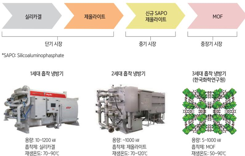
그림2의 개발 전략에서 제시한 바와 같이 비표면적이 실리카겔과 제올라이트에 비해 3~5배 이상 높고, 수분 흡착 용량도 그에 비례하여 높다. 이러한 MOF 수분 흡착제는 일반적으로 골격에 친수성 부분과 소수성 부분을 동시에 보유하고 있어서 수분의 선택적 흡착과 저온에서의 용이한 탈착이 가능할 수 있다. 그림3에 나타난 바와 같이 수분 흡착제 개발 방향은 현재 상용화되어 있는 1세대 실리카겔 흡착제 기반의 흡착식 냉방 장치와 시장에 진입 단계에 있는 2세대 제올라이트 흡착제 기반의 흡착식 냉방 장치에 이어서 궁극적으로 MOF 흡착제 기반의 3세대 흡착식 냉방 장치가 모두 사업화 되는 것이다. 이러한 3종류의 흡착식 냉방 장치가 사업화 될 경우 시장의 다양성이 공존하게 되고 경쟁력이 강화되어 흡수식 냉방 장치 시장과 함께 전기식 에어컨과 가스연소식 에어컨 시장을 부분 대체할 수 있을 것으로 기대된다.
