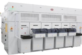
해 Base Wafer에 Core Die를 적층하는 초정밀 본딩 장비입니다. 두 개의 본딩 헤드를 동시에 작동시켜 발생하는 진동 등 기술적인 난제를 해결하여 경쟁사 본딩 장비에 비해 생산성 2배, 장비 소형화, 초정밀 본딩을 모두 만족시킵니다.
