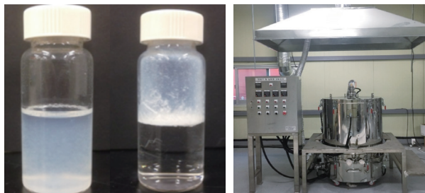
그림 2 발수코팅 전후 분말의 발수성 평가(좌) 및 발수코팅 장비 사진(우)
