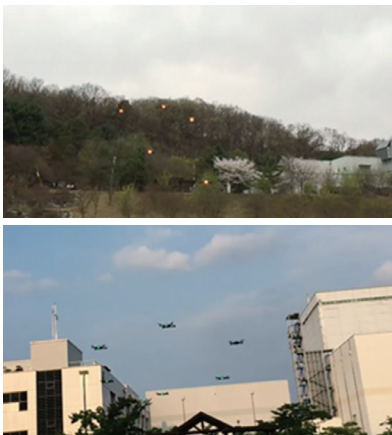
그림 7 GPS 기반 군집 비행(상)와 RTK-GPS 기반 군집 비행(하) 비교 시험
