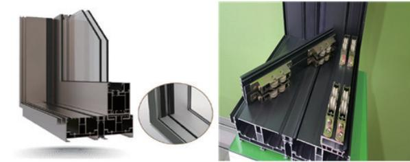
조립구조 기술'은 단면(斷面) 형상이 일측면으로 개방된 'C'자형 롤러지지대를 사용함으로써 창틀 프레임 상면에 노출된 홈의 개수를 줄여 기밀성과 수밀성을 향상시켰다.
