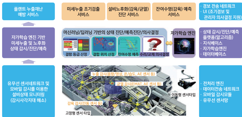
그림 6 스마트센서 네트워크 및 자가학습 기반 누출 재난 예방 전문가시스템 개념도
