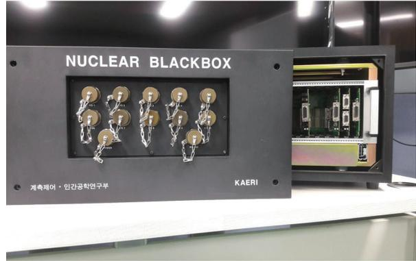
원전 블랙박스 개발에서 가장 어려운 점은 고 방사선 및 고온에 견딜 수 있는 전자회로 설계(Radiation Hardened Electric Circuit Design)이다. 일반적으로 전자회로의 구성품인 반도체들은 에너지를 갖는 방사선에 노출되면 TID(Total Ionizing Dose) 및 SEE(Single Event Effects)에 의해 이상 동작을 하게 된다. TID 효과는 누적 방사선량에 의한 것으로 반도체가 방사선에 노출되면 내부에 이온화가 발생하게 되고 이로 인해 문턱전압(Threshold Voltage)이 변화되어 이상 동작이 발생하고 심화되면 회로 기저를 파손시키는 것을 말한다. 그리고 SEE는 고 에너지를 갖는 방사선에 노출된 아날로그/디지털 반도체 회로가 순간적 이온화로 인해 발생하는 전기신호에 대한 오류를 말한다.
