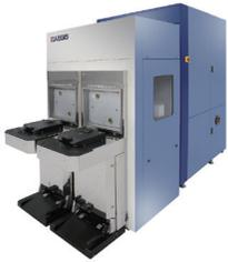
검출하는 장비로서 반도체 소자 제조 기업의 단위 공정 기술 개발과 수율 향상에 기여하는 핵심 장비입니다. 대면적 2차원 이미지 획득 기술, 이미지 비교를 위하여 이미지들을 정렬하는 고속 이미지 프로세싱 기술, 암조명과 명조명 사용이 가능한 다중 조명 광학 기술, 정밀한 패턴 결함 위치 정보 획득 기술이 특징적입니다.
