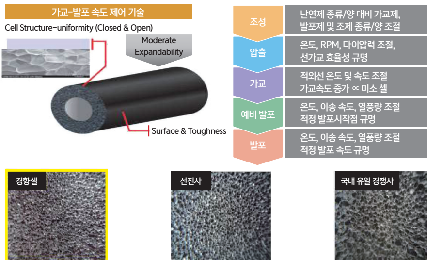
그림 3 가교-발포 속도 제어 개념도 및 셀 구조
