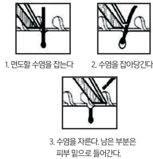
그림 3 필립스 Lift and Cut 면도기(좌)와 면도 주기를 늘린 면도기 원리(우)
