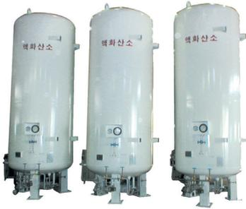
도로 쓰이고 있다. 고압가스안전관리법상 초저온 용기는 외부에서의 열침에 의한 액온의 상승, 즉 용기 압력의 상승을 방지하기 위하여 단열을 실시하여 침입 열량을 규정치 이하로 하여야 하고, 용기 재료는 저온취성을 일으키지 않는 오스테나이트계 스테인리스강 또는 알루미늄 합금을 사용하여야 한다. 종래의 초저온 용기의 구조는 오스테나이트계 스테인리스강으로 된 내조가 탄소강 등으로 된 외조의 내부 공간에 설치된 이중의 구조를 가지고, 내조 상단의 내조 상부헤드에 열전도가 적고 강도가 큰 재료의 지지재가 외조의 상단에 고정 지지된 구조를 가진다. 외조와 내조의 공간에는 분막진공단열법이 적용되는데, 이는 펄라이트라는 구조토를 내외조 사이에 다지고  $5^{-10^{29}}$ Torr의 고진공으로 형성시켜 단열하는 방법이다.
