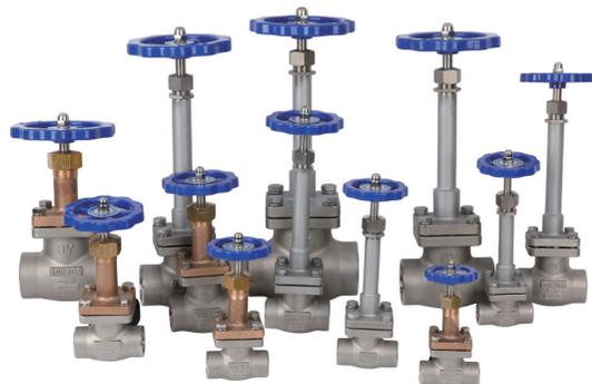
을 기술했다. 초저온 글로브 밸브는 LNG선 저장탱크의 배관용 밸브, 실험용 초저온 액화가스 배관의 밸브에 사용할 수 있으며, 10A부터 50A까지 총 7종으로 스테인리스강 FC8 재질로 제조했다. 초저온 글로브 밸브를 개발함으로써 타사의 밸브를 대체해 각종 부가가치가 창출된다는 점에서 큰 의미가 있는 개발이다. 그리고 개발제품 중 기존의 초저온 글로브 밸브와는 다르게 액화가스 상태로 장시간 보관이 용이하고, 고효율 단열기능이 있다. 또한 유체가 매우 높은 압력에서 매우 낮은 온도로 유동하여도 누설 및 동결이 방지되며 사용시점에서 높은 품질, 극저온 상태가 유지되며 액화가스 상태로 장시간 보관에 용이한 밸브이다. 이러한 이중 진공으로 된 극저온 유체용 밸브를 개발로 NET(신기술) 인증을 받는 등 기술력을 인정받았다. 이 외에도 특허 1건, CE 해외 인증 등 여러 노력을 기울이며 개발에 매진하고 있다.
