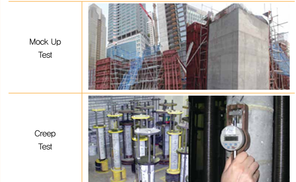
그림 5 고성능 콘크리트 실험
