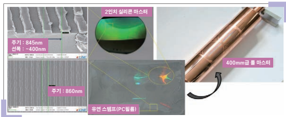
그림 4 간섭 리도그래피와 나노임프린트 공정으로 제작한 나노패턴 롤 마스터
