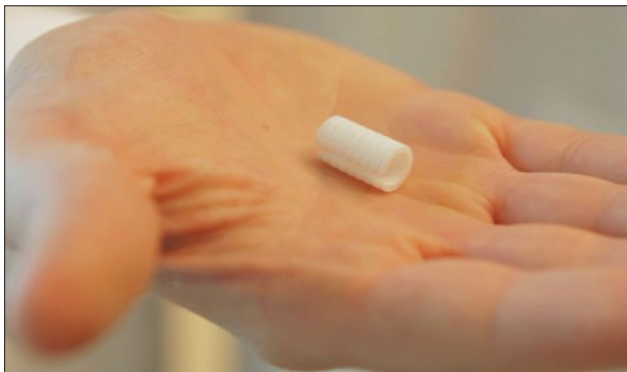
그림 1) 수술에 사용된 3D 프린트 환자맞춤 디바이스
