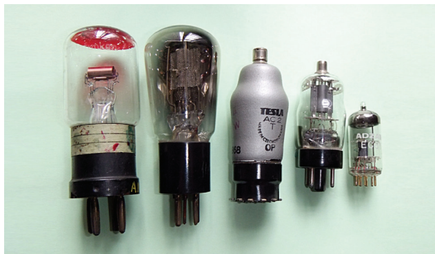
그림 1> 트랜지스터의 모체였던 진공관의 발달(1918~1953). 좌에서 우로 갈수록 크기가 작아진다.
