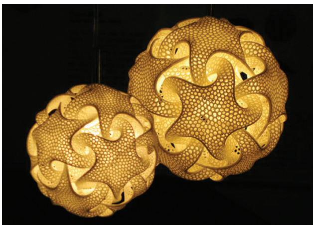
그림 4) SLS 공정으로 직접 생산된 Bathsheba Grossman 의 조명 갓 출처: 벨기에 Materialise사 제공
