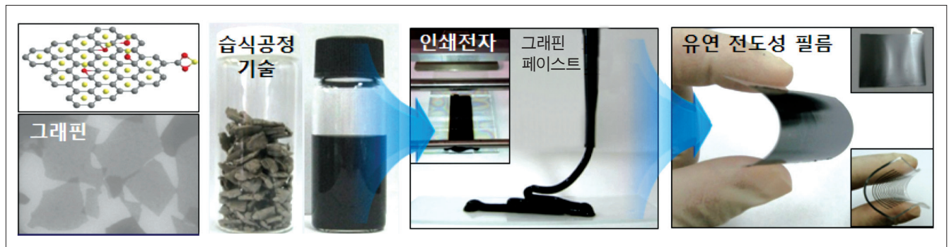
그림 2) 대면적/고품질 그래핀 대량제조 및 유연전극 응용기술
