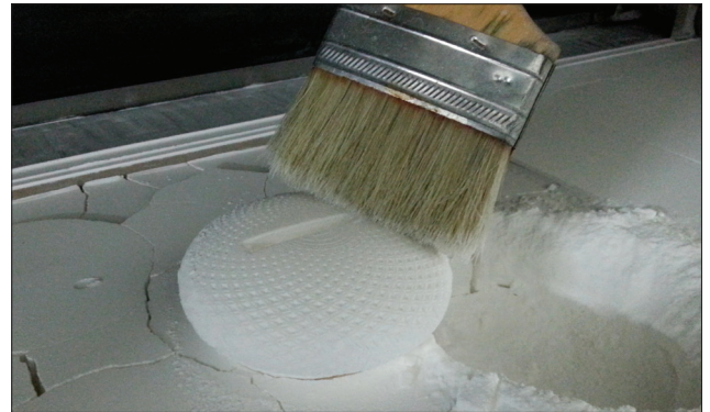
그림 1) SLS 방식의 경우 출력 후 파우더 안에서 제품을 꺼내야 한다.
