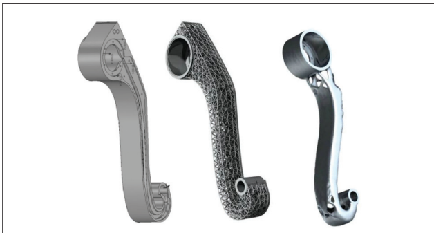
그림 6) AM 방식의 양산을 위한 디자인 최적화 출처: Loughborough University
