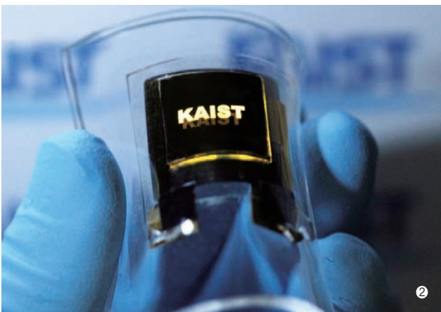
그림 5) ① 플렉시블 배터리는 휘어도 전압이 일정해 LED 전구의 밝기가 바뀌지 않는다. ② 이 배터리를 휘어지는 디스플레이와 결합한 결과, 글자가 나타난다(자료 : KAIST 이진재 교수팀).
