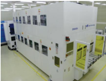
삼성전자와 티케이씨가 공동개발한 '반도체 12인치 웨이퍼 도금장치'는 반도체 제조 공정인 FAB에서 생산적용이 가능한 12인치용 전자동 Wafer 도금장치입니다. 이 장비는 기존의 100% 수입에 의존했던 반도체 도금 분야 장비의 국산화라는 점에서 매우 중대한 의미를 가지며 도금 제품에 대한 신뢰성 및 재현성 등의 품질적인 부분 또한 해외 선진장비에 크게 뒤지지 않는 독자적인 기술을 보유한 장비입니다. 이 기술을 개발한 티케이씨 서운호 부사장과 권택관·한민석 이사를 필두로 한 연구팀은 개발된 장비에 대한 완성도를 더욱 향상시켜 실질적인 대외 판매 시장에 진출할 수 있는 장비로 만들겠다는 목표를 세우고 계속 전진하고 있습니다. 이를 위해 당 기술을 적용한 단독 평가용 설비의 개발을 촉진하는 한편, 산·학·연 등의 원천기술 개발처에도 공급하여 국내의 Wafer, LED, Solar 등의 도금 분야에 대한 적용 확대 및 공정 개발을 진행할 것이라고 합니다. 기술경영
